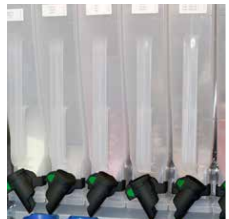
„SiTwist'n-Lock“: Der Verschluss der Instantbehälter mit einer optischen Anzeige für offen (grün) und verschlossen (rot)
